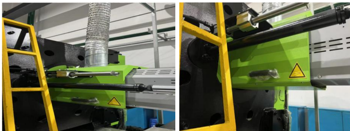
图 4-1 注塑废气收集示意图
