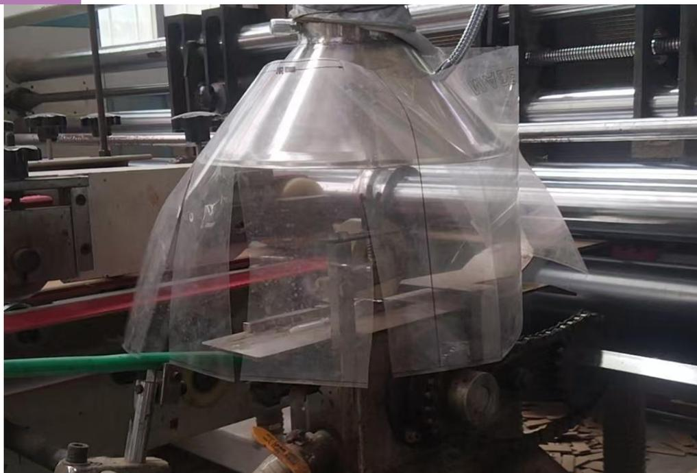
图 4-1 项目废气收集罩示意图
