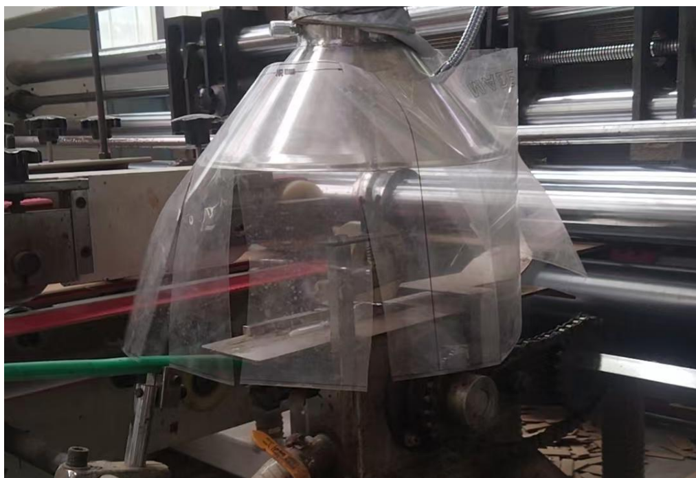
图 4-1 项目废气收集罩示意图
