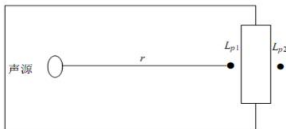
图4-2 室内声源等效为室外声源图例
