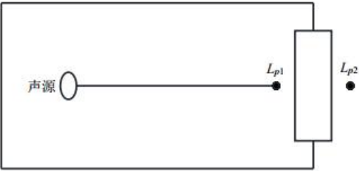
图 4-2 室内声源等效为室外声源图例
