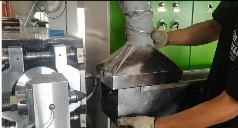
图4-1 注塑、押出废气收集系统示意图
