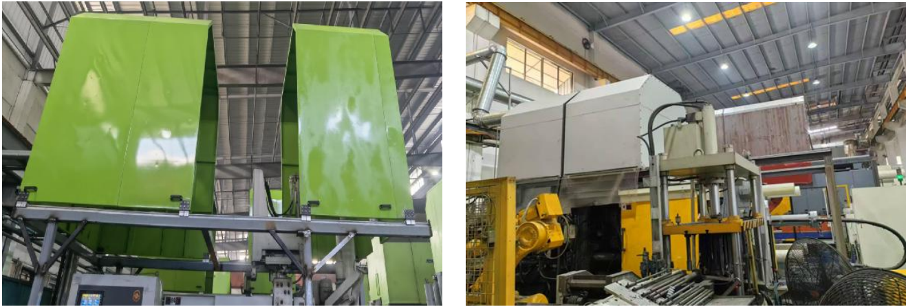
图 4-1 项目压铸工序废气收集罩示意图
