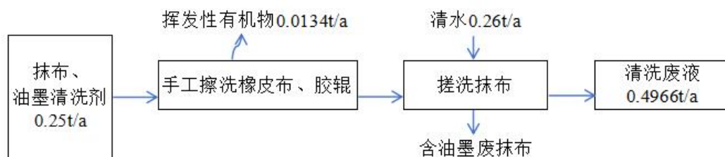
图 2-1 清洗废液产生流程
