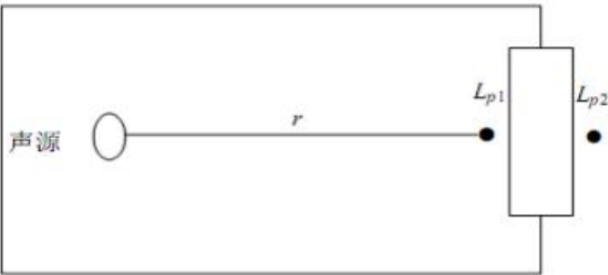
图 4-2 室内声源等效为室外声源图例
