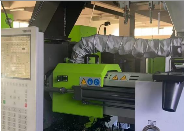
半密闭型集气罩示意图
