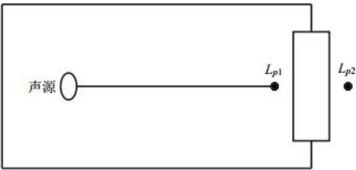
图 4-2 室内声源等效为室外声源图例
