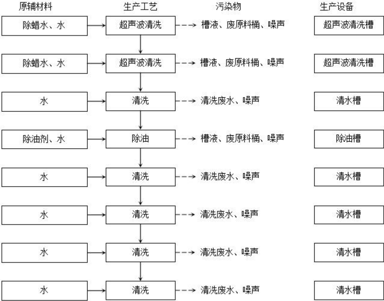
图 2-4 超声波清洗线工艺流程图
