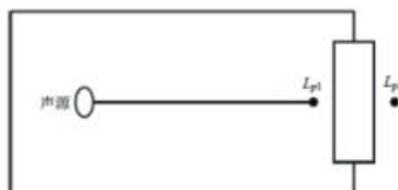
图4-2 室内声源等效为室外声源图例
