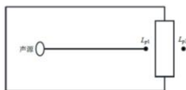
图 4-2 室内声源等效为室外声源图例
