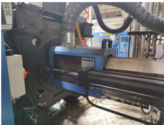
图 1 注塑废气收集方式示意图
