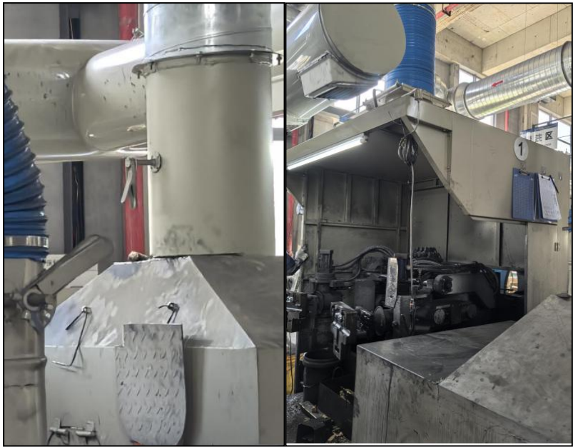
图4-2 熔化（左）、压铸（右）废气收集示例图
