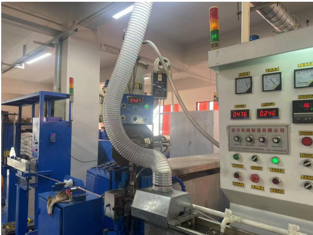
图 4-2 开炼机产废点收集措施示意图
