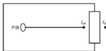
图 4-2 室内声源等效为室外声源图例
