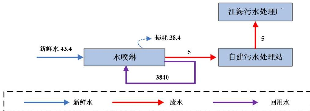
图 4-1 本次改扩建项目粘结钨铁硼生产线水平衡图（单位 t/a）
