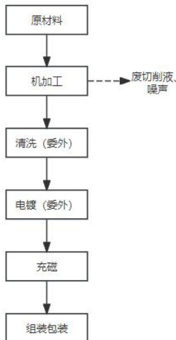
图 2-4 烧结钕铁硼生产工艺流程
