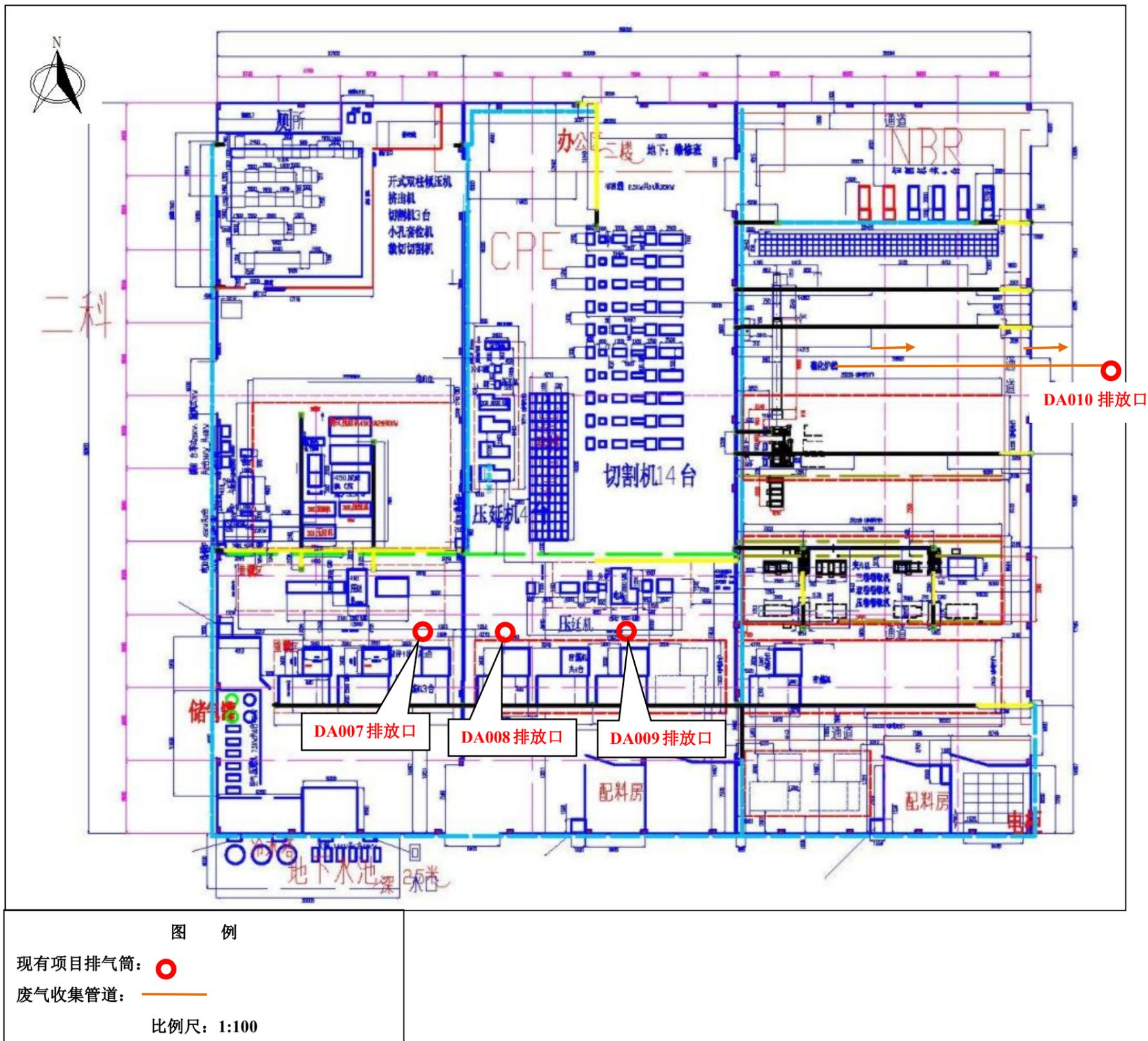
附图4 橡胶磁生产线（现有项目生产线）车间平面布置示意图
