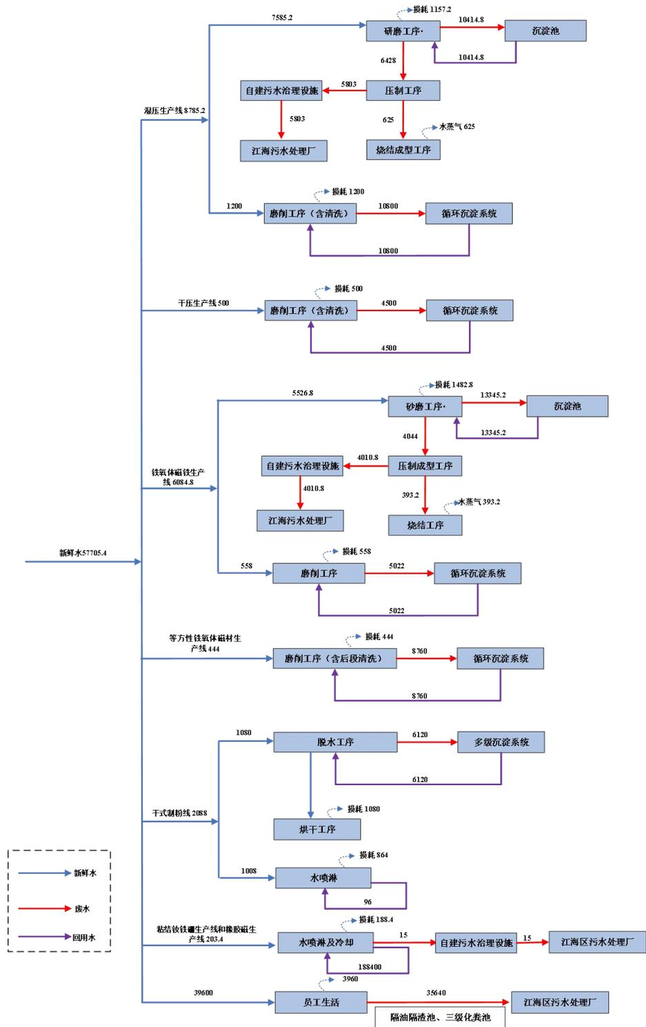
图 2-2 扩建后全厂项目水平衡图 (单位 t/a)
