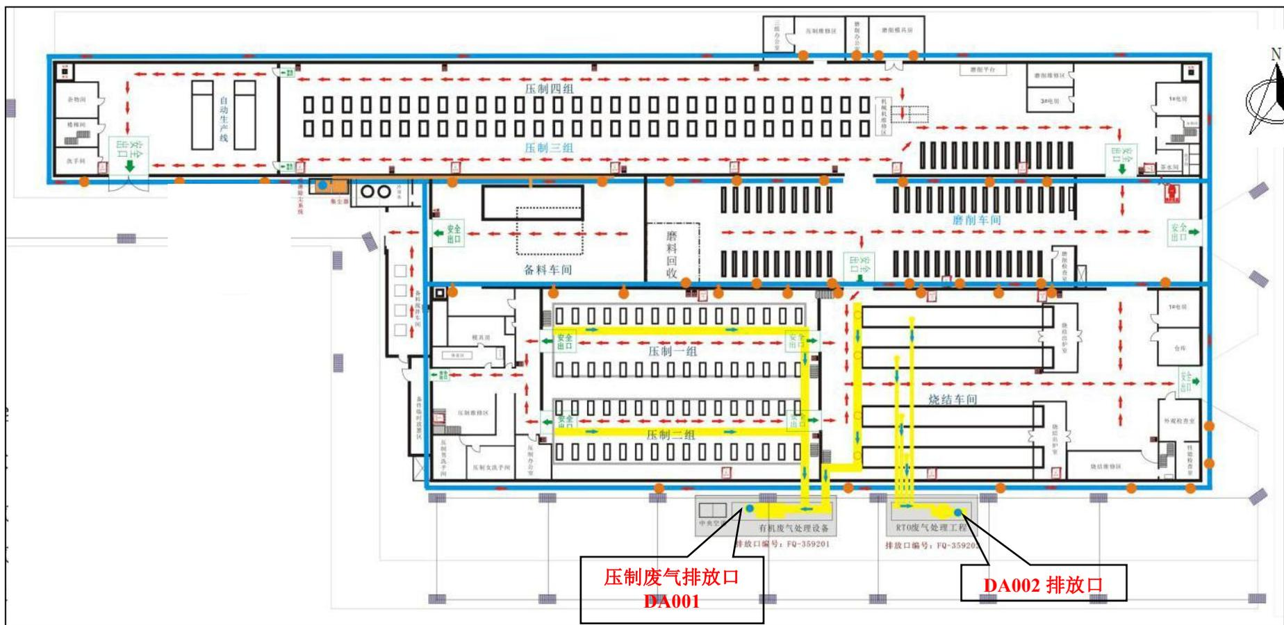
附图 4 干压生产线（现有项目生产线）车间平面布置示意图
