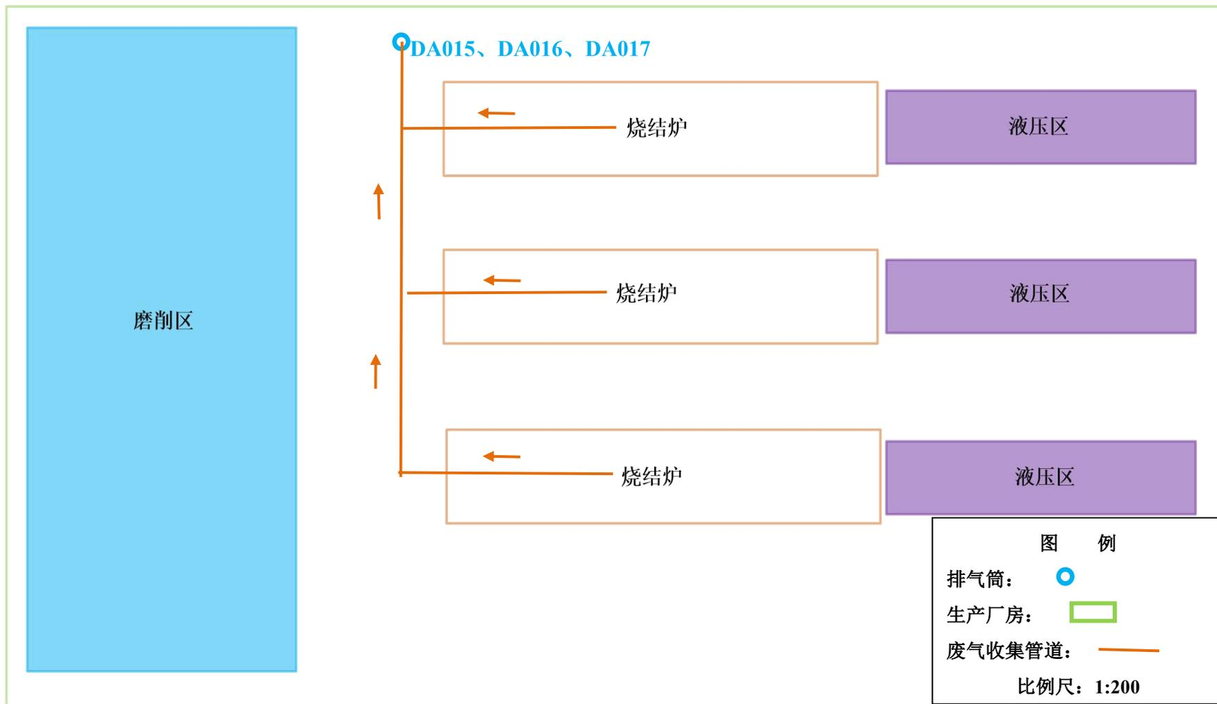
附图 4 湿压 D 车间（现有项目生产线）平面布置示意图
