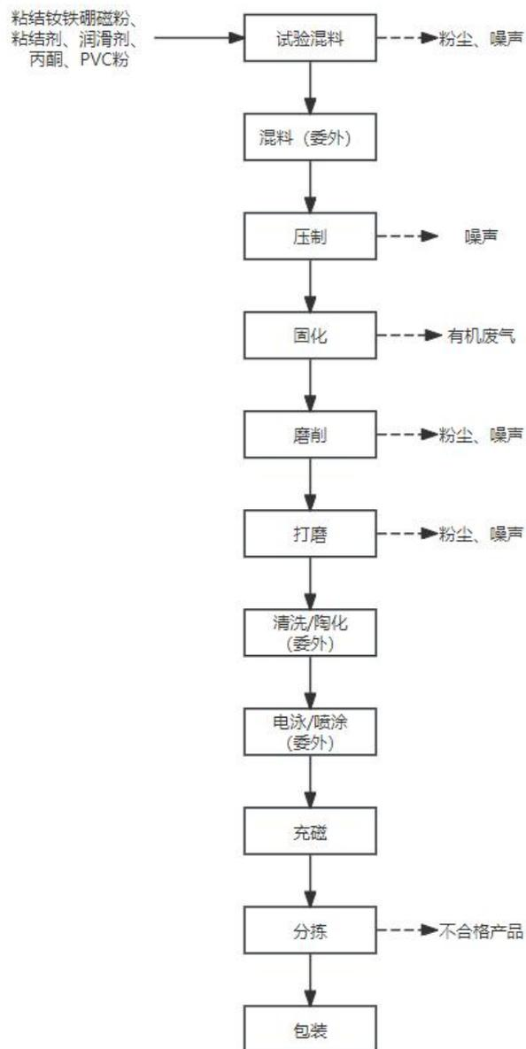
图 2-3 粘结钕铁硼永磁体生产工艺流程
