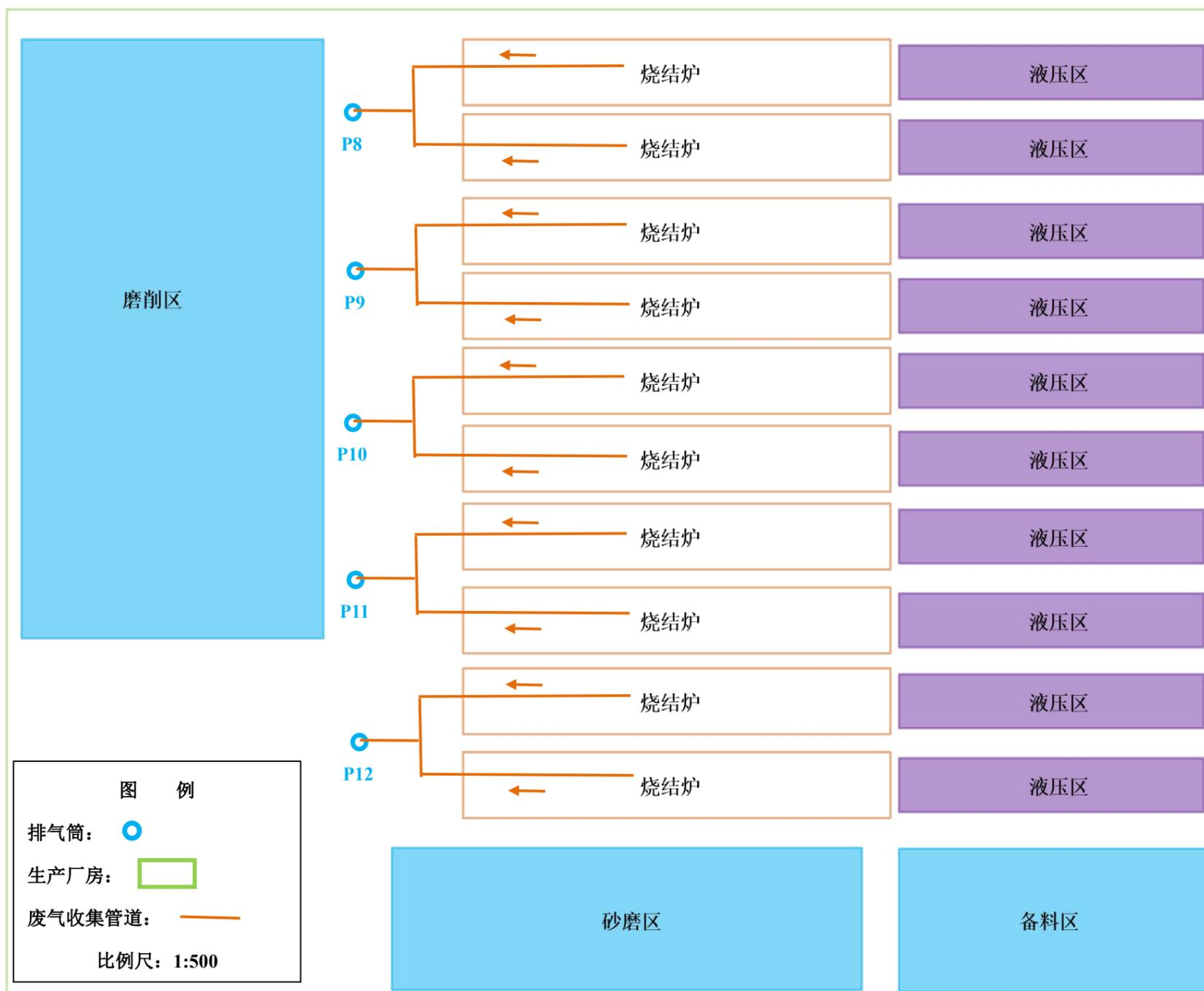
附图 4 湿压二期车间（现有项目生产线）平面布置示意图（已批未建）
