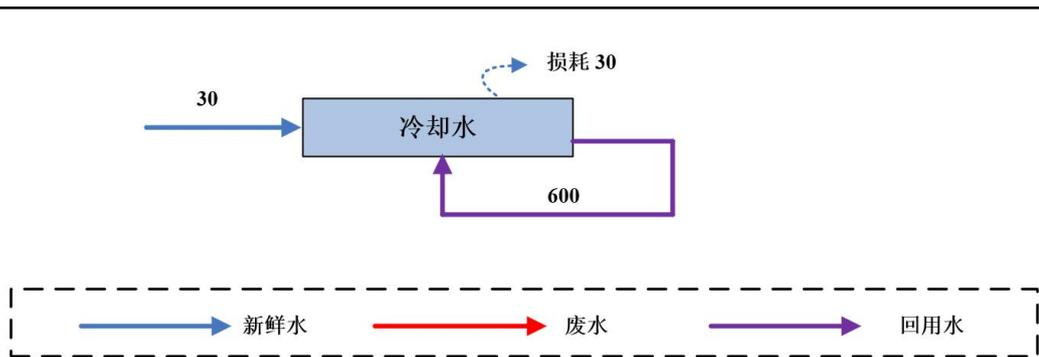
图 4-2 本次改扩建项目烧结铁硼生产线水平衡图（单位 t/a）
