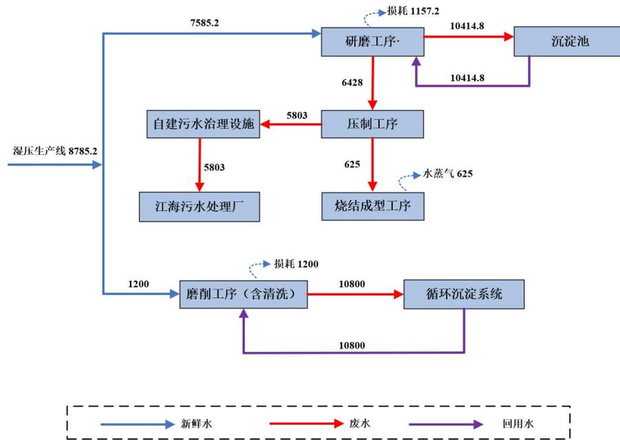
图 4-5 本次改扩建项目湿压生产线水平衡图（单位 t/a）
