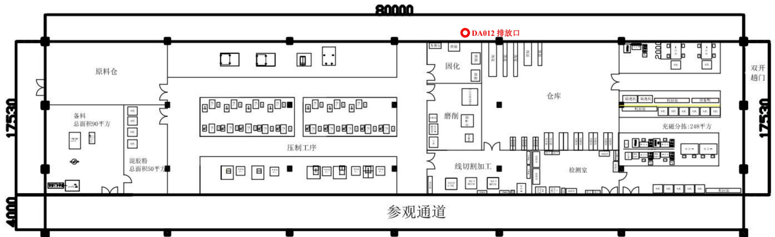
附图 4 粘贴钕铁硼生产线（本次改扩建项目生产线）车间平面布置示意图
