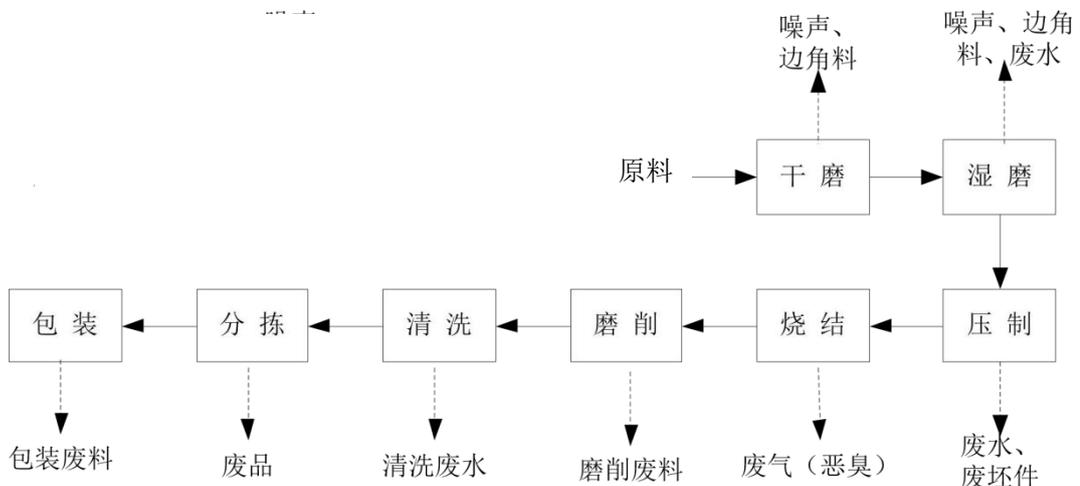
图 2-11 湿压工艺流程图
