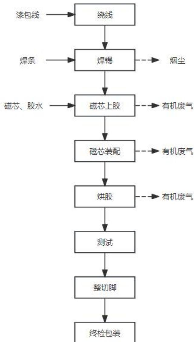
图 2-5 电感组装生产工艺流程
