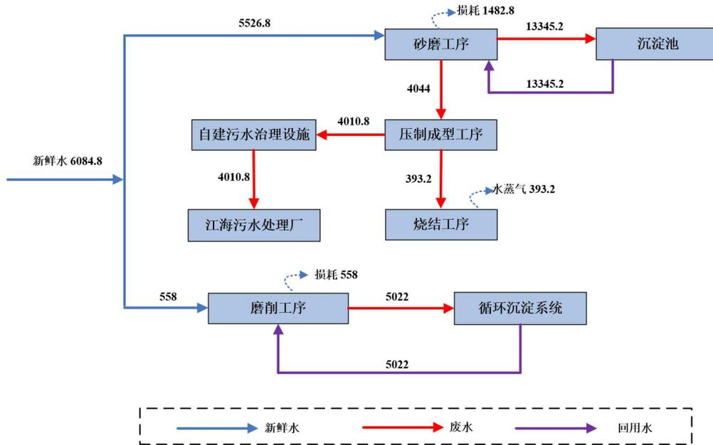
图 4-4 本次改扩建项目铁氧体磁铁生产线水平衡图（单位 t/a）
