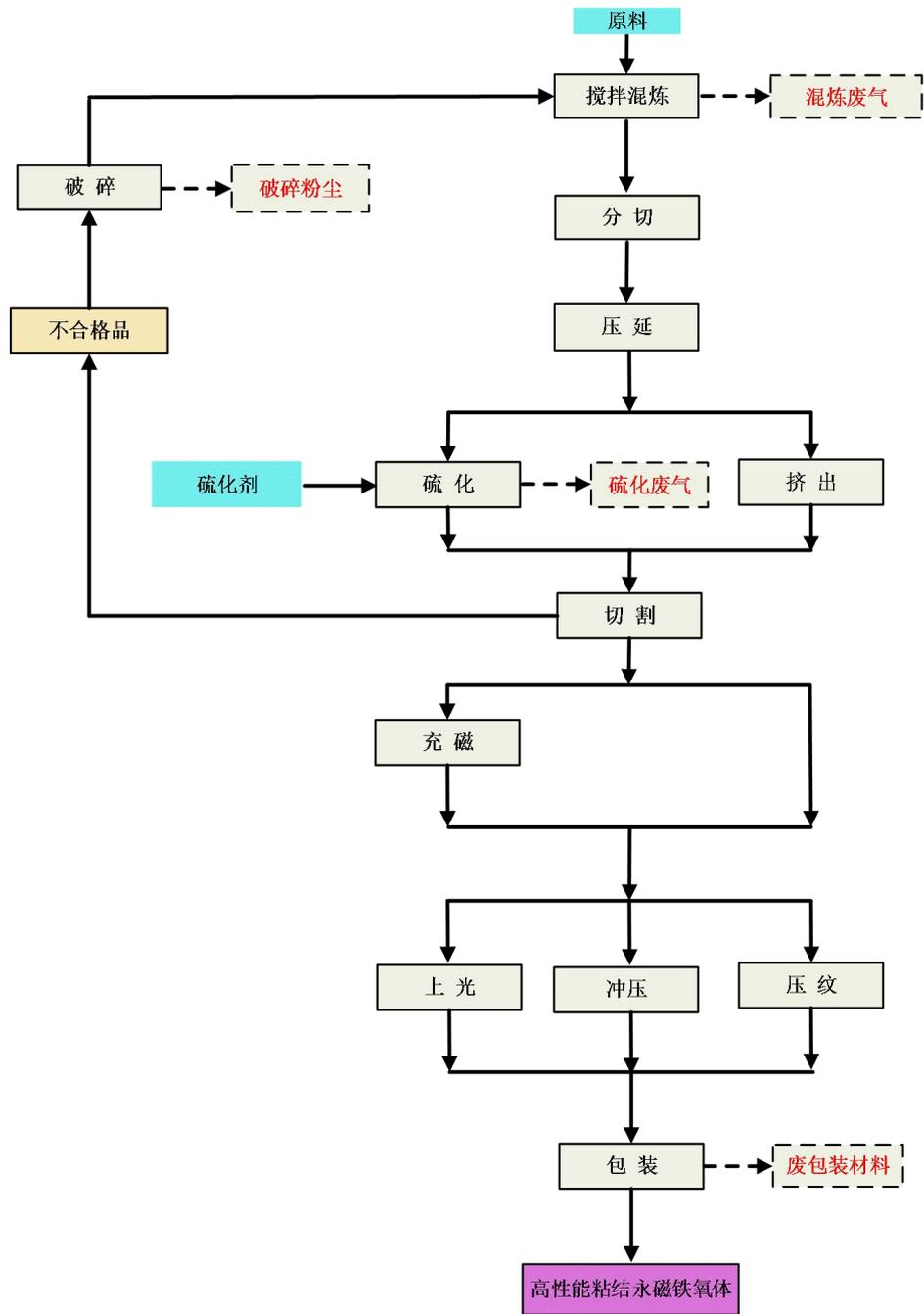
图 2-6 橡胶磁生产线工艺流程图（本次扩建）
