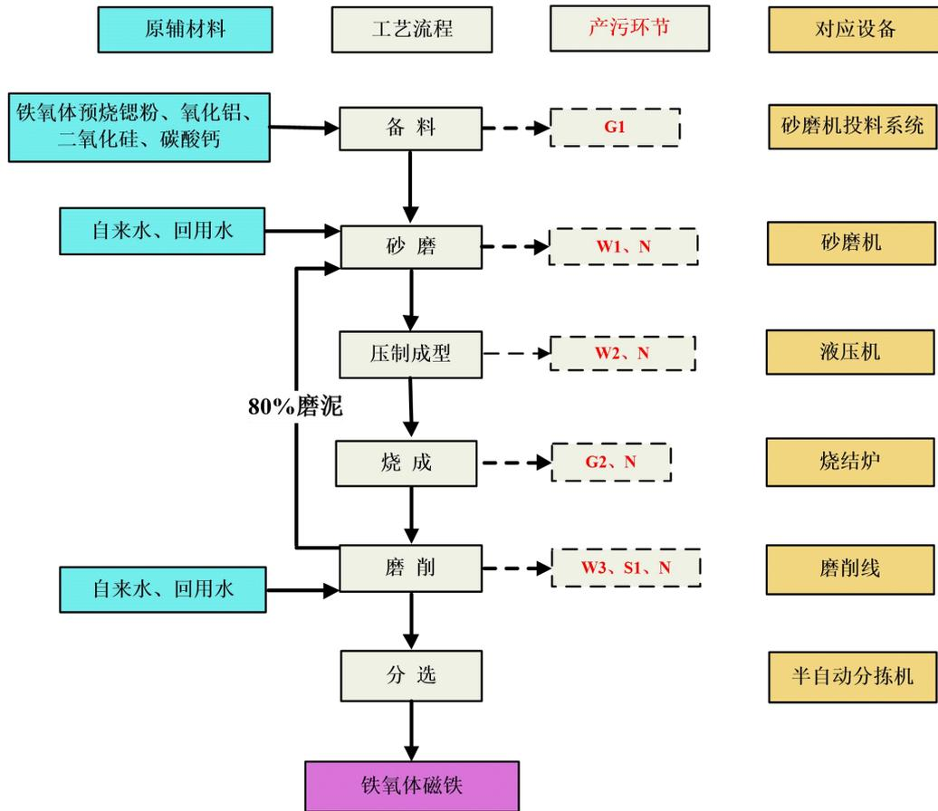
图 2-7 生产工艺流程图（铁氧体磁铁）
