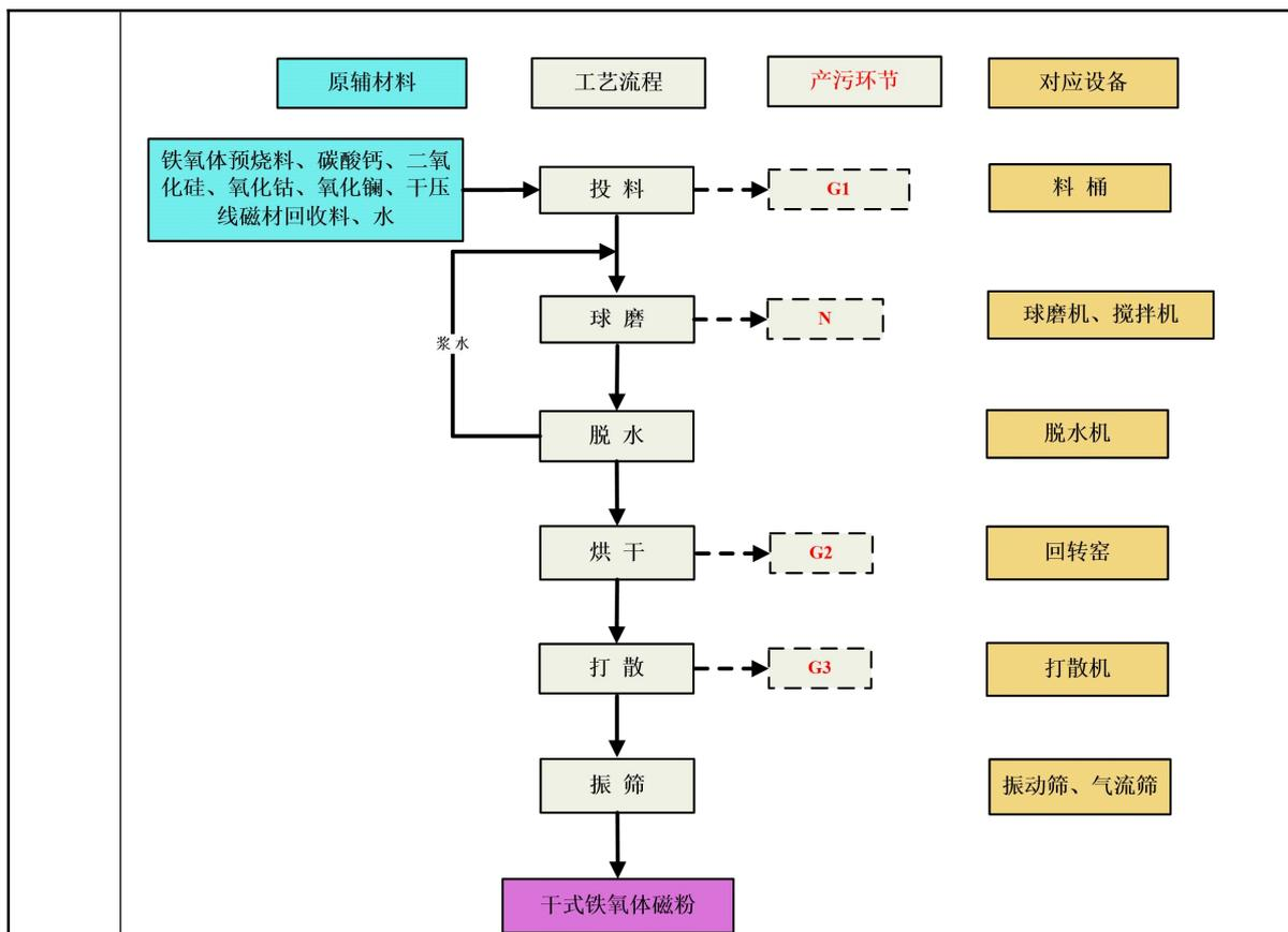
图 2-9 项目生产工艺流程图（干式制粉线）
