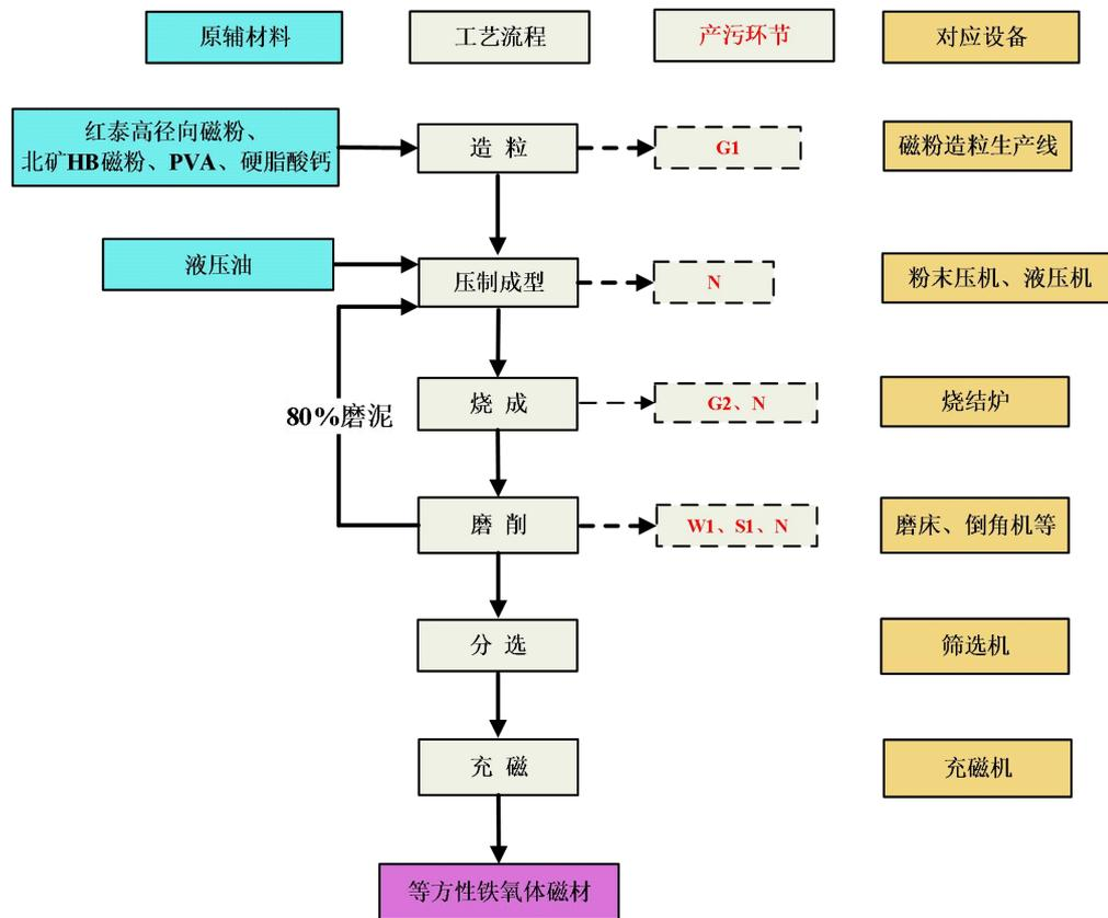
图 2-8 项目生产工艺流程图（等方性铁氧体磁材）
