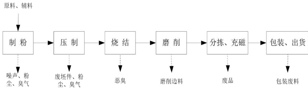
图 2-10 干压工艺流程图
