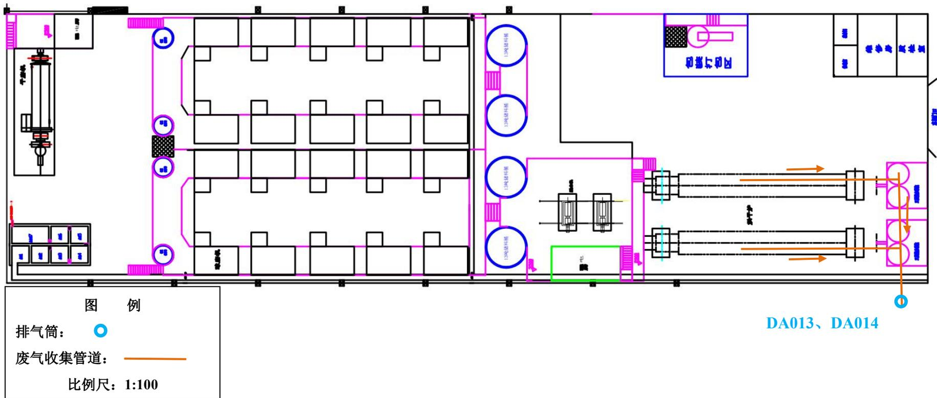
附图 4 干式制粉线（现有项目生产线）车间平面布置示意图
