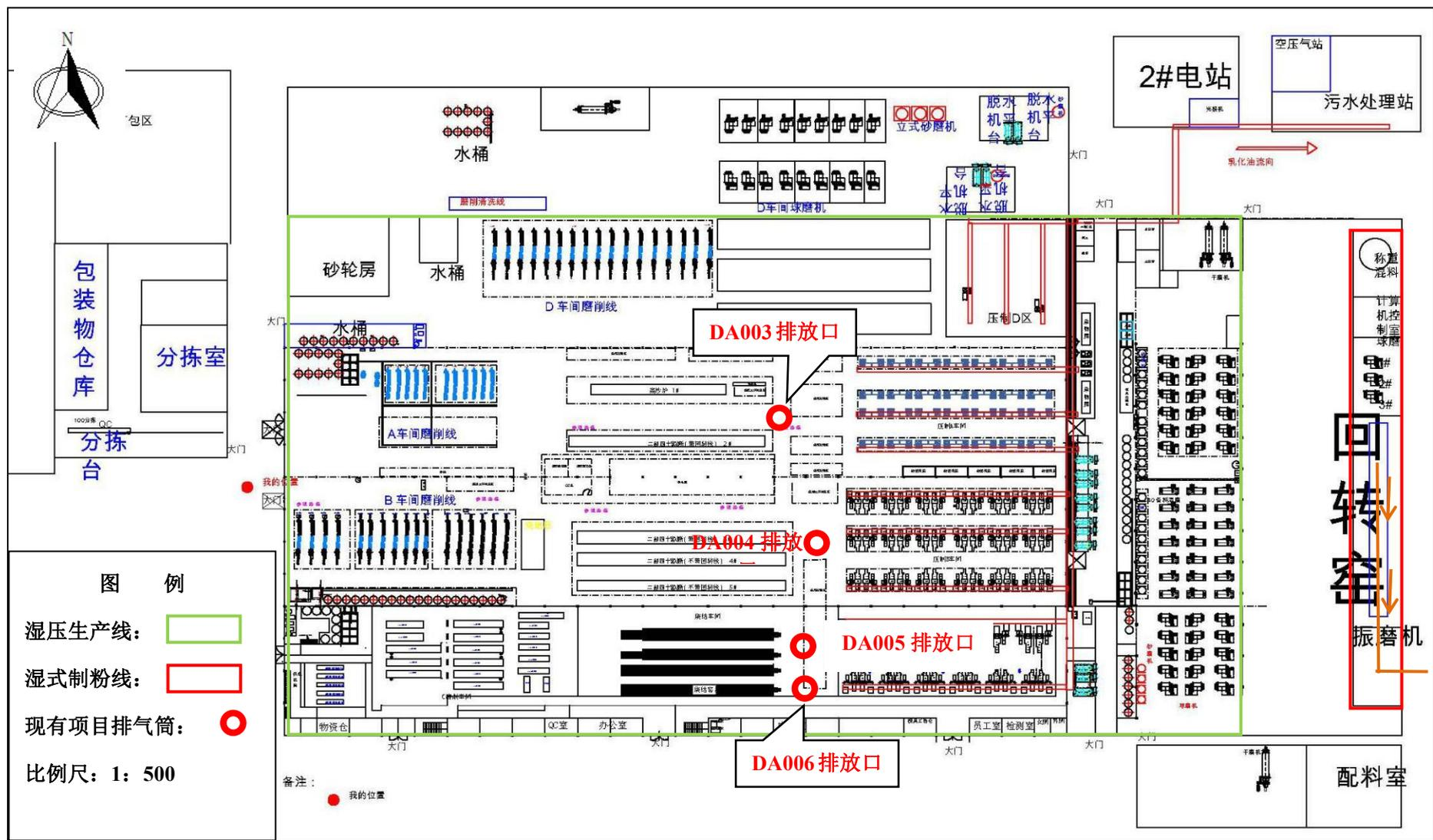
附图 4 湿压生产线（现有项目生产线）及湿式制粉线（现有项目生产线）车间平面布置示意图
