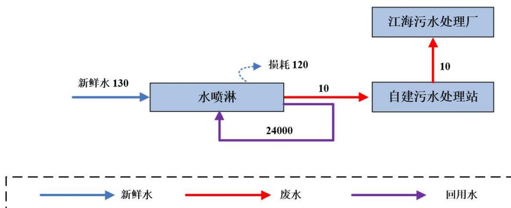
图 4-3 本次改扩建项目橡胶磁生产线水平衡图（单位 t/a）
