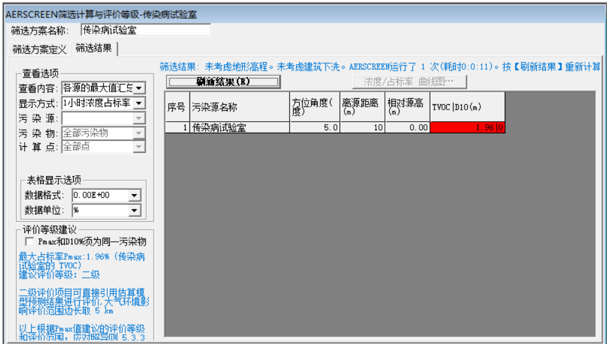
图 2.6-5e 面源——公共卫生中心传染病楼实验室 (TVOC) 最大地面浓度占标率
