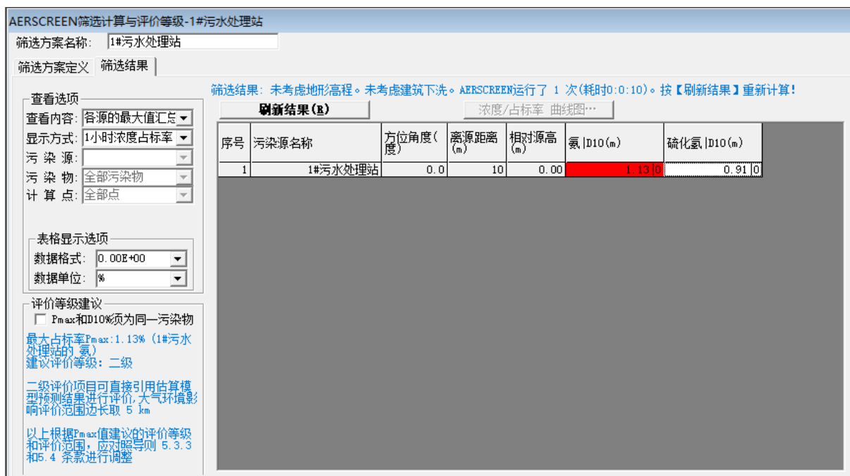
图 2.6-5h 面源——1#污水处理站（氨、硫化氢）最大地面浓度占标率
