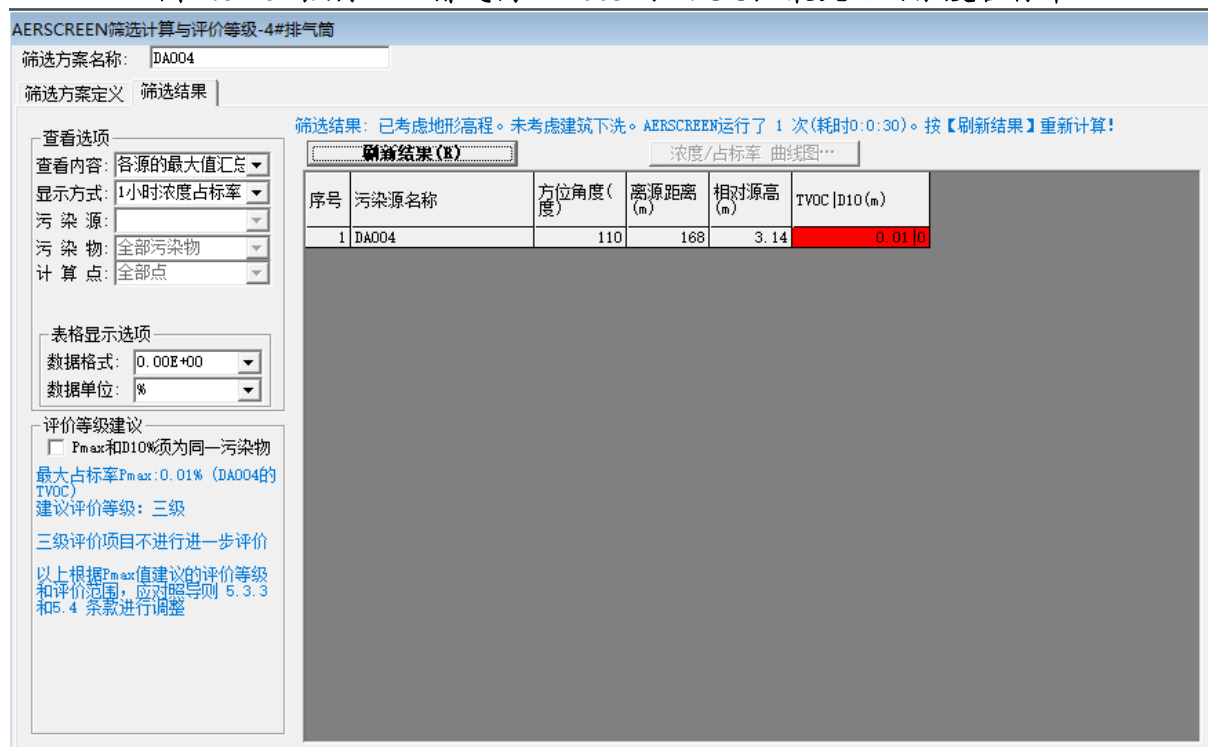
图 2.6-4d 点源——排气筒 DA004 (TVOC) 最大地面浓度占标率
