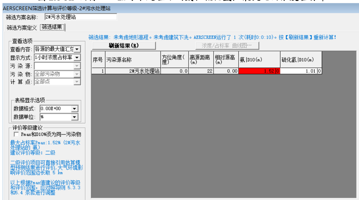
图 2.6-5i 面源——2#污水处理站（氨、硫化氢）最大地面浓度占标率
