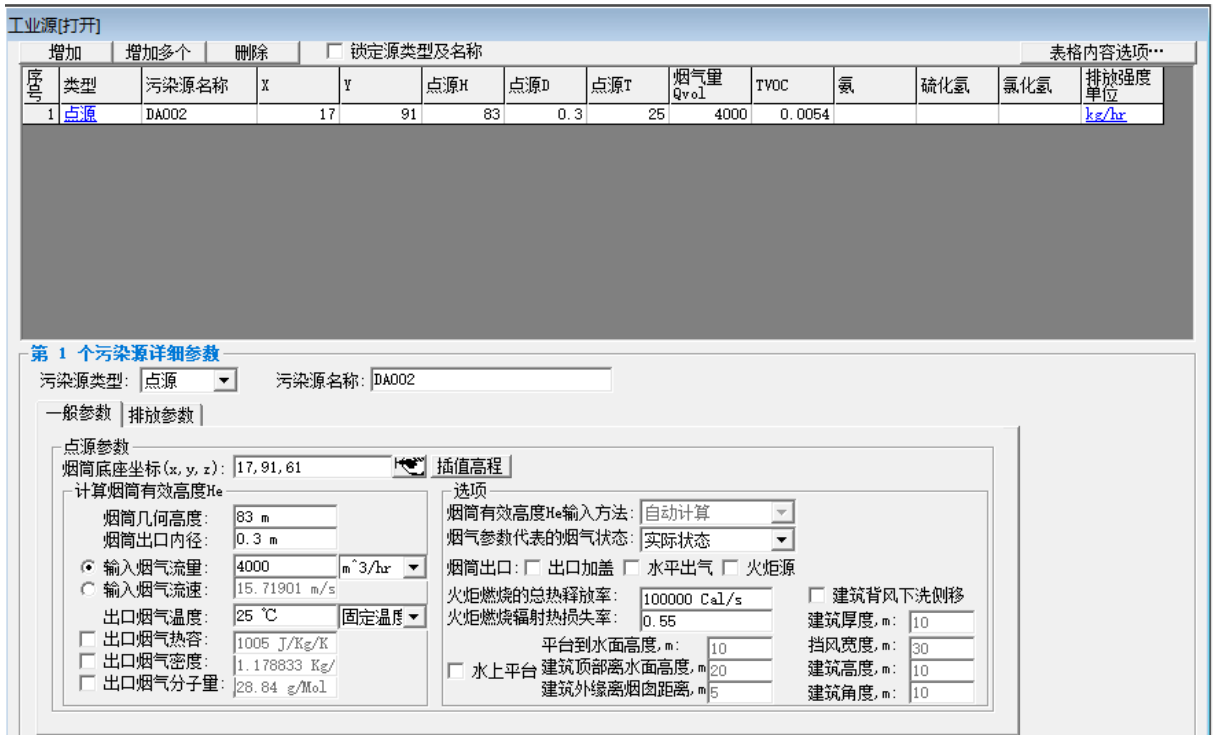
图 2.6-2b 估算模型参数输入截图——排气筒 DA002 污染源参数
