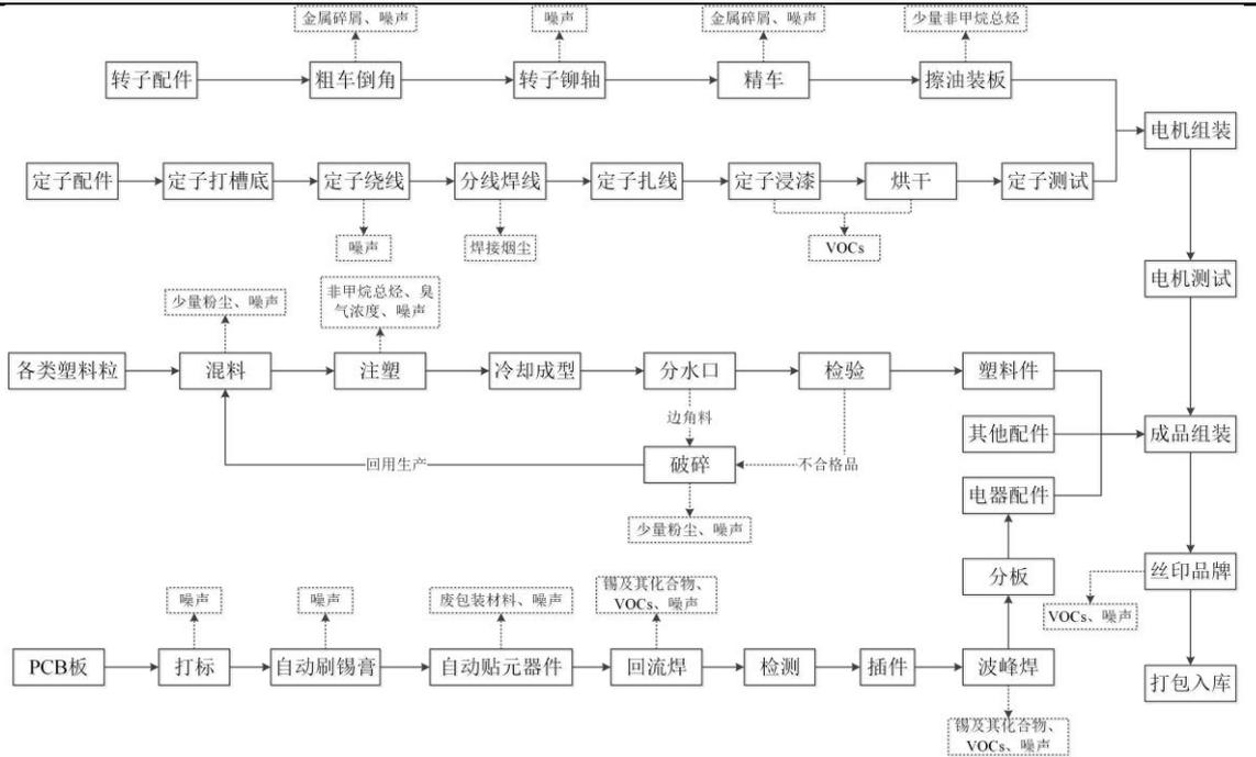
图 2-2 产品零部件生产工艺流程图
