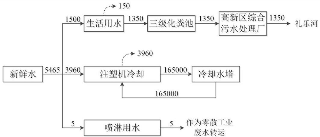
图 2-1 改扩建项目水平衡图 (m<sup>3</sup>/a)
