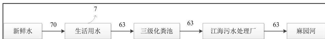
图 2-1 项目水平衡图 (m<sup>3</sup>/a)
