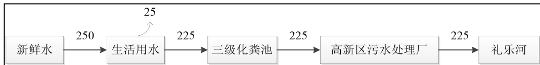
图 2-1 项目水平衡图 (m³/a)
