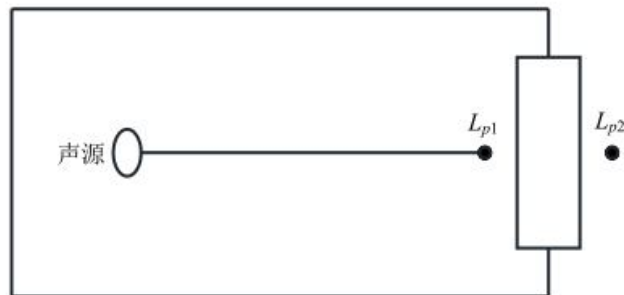
图 4-3 室内声源等效为室外声源图例
