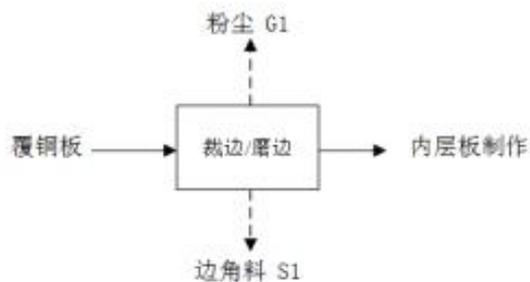
图 2-5 开料工艺流程图及产污环节图
