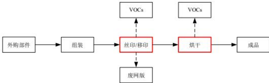
图 2-7 打蛋机、搅拌机生产工艺流程
